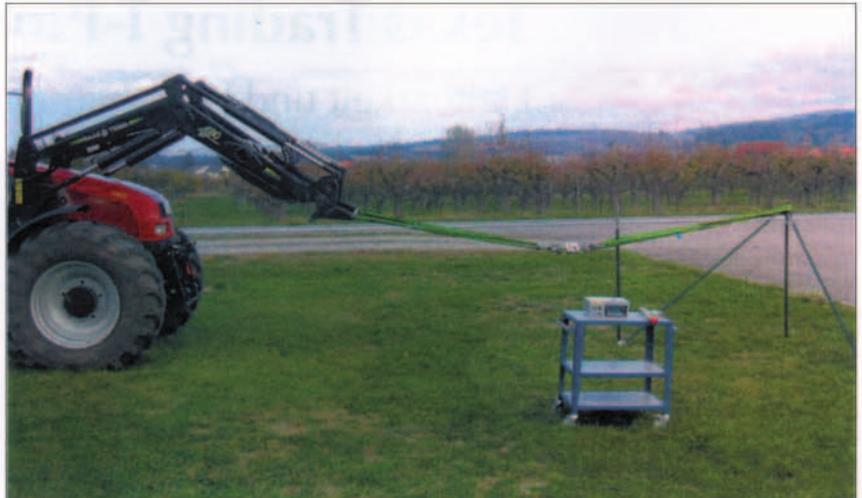
Bild 4: Überprüfung der Stabilität der Eckverbindungen
